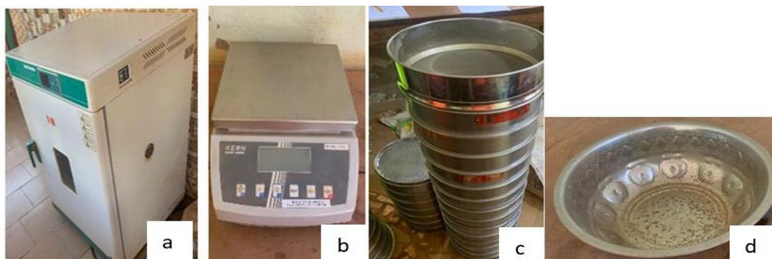
Figure 2 : Matériel pour l'analyse granulométrique (a-étuve ; b- balance électronique ; c-colonne de tamis ; d- tare)
